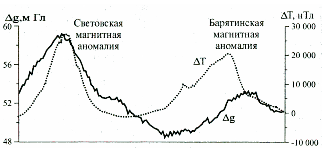
Рис.3.15.4. Графики магнитного и гравитационного полей по профилю, пересекающему Барятинскую и Световскую магнитные аномалии.
