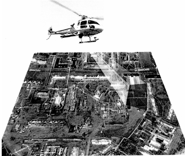
Рис. 6.1. Тепловизионная аэросъемка тепловых сетей: единственный способ в короткий срок выявить аварийные и потенциально-дефектные места на протяженных участках тепловых сетей.
