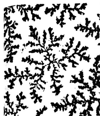
Рис. 1.5.9. Поверхностный кластер  $NbGe_2$ , образуемый на кварцевой подложке при высокочастотном вбрызгивании ниобия в пары германия.
