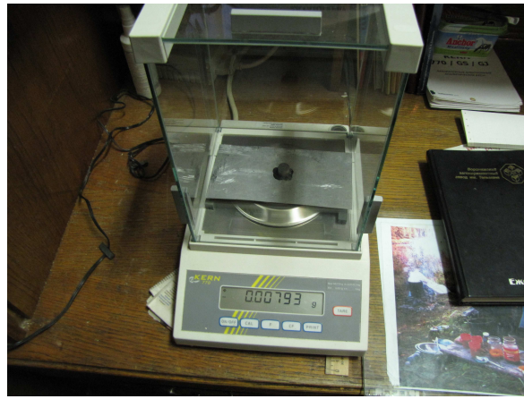
Рис.1. Взвешивание стального цилиндра-магнита на столике-подставке северным полюсом вверх (не касаясь чашечки весов).
