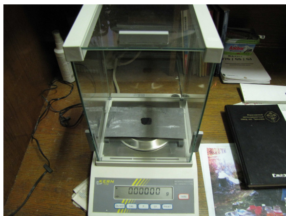
Рис.2. Фиксация нулевого веса при отсутствии стального цилиндра-магнита на столике-подставке (не касаясь чашечки весов).
