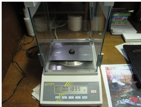
Рис.3. Взвешивание стального цилиндра-магнита на столике-подставке северным полюсом вниз (не касаясь чашечки весов).
