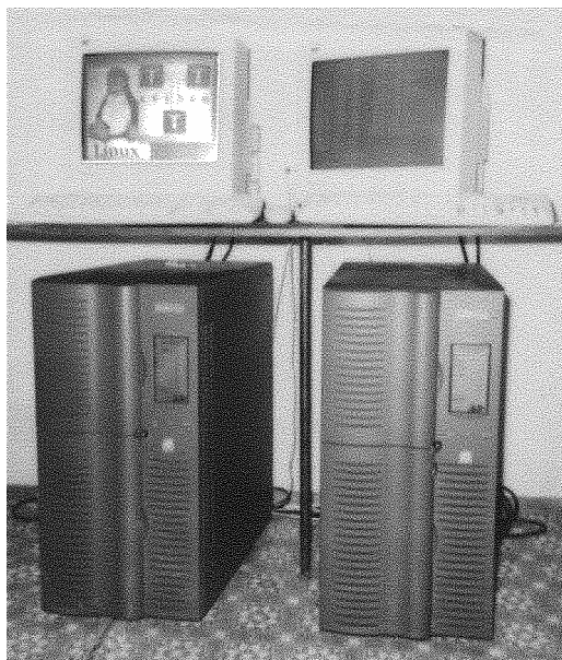
два шестипроцессорного узла 6×PPro/200 (ALR Revolution 6x6)
