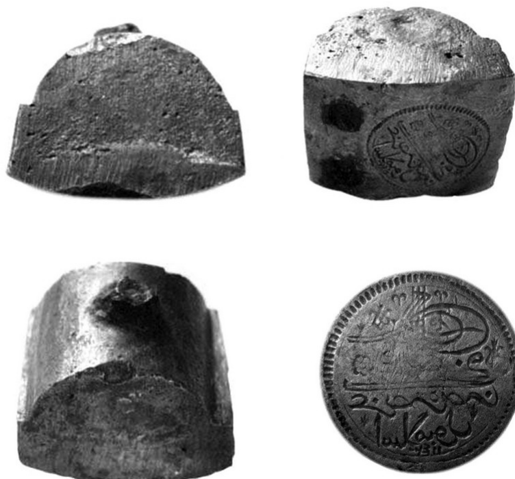
Рис. 3. Сменный штемпель для вальцевальной машины из Чуфут-Кале (по А.С. Бойко-Гагарину)
