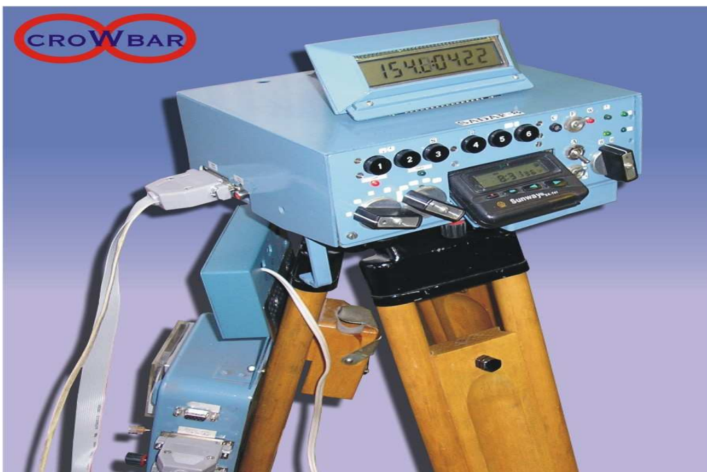
Рис. 15. Анализатор структурно-динамических неоднородностей SADAF-08LC на штативе, с навесным оборудованием.
