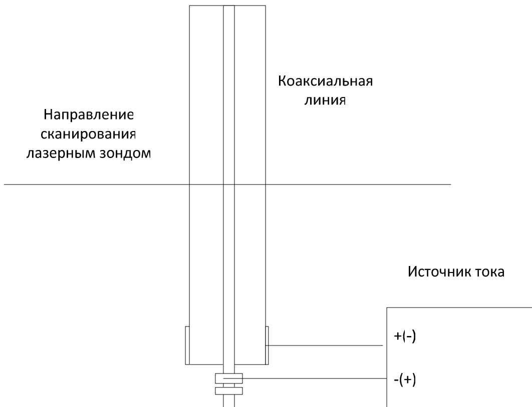
Рис. 22. Схема исследуемой коаксиальной линии.
