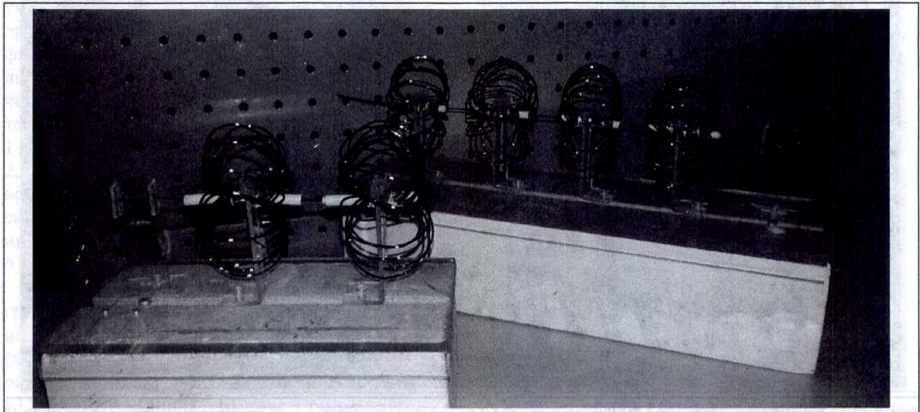
Рис. 3. Фото конструкций двухэлементной (слева) и четырехэлементной (справа) ФАР с элементами в виде пятнадцатилистников
