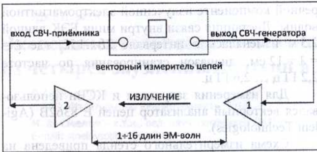
Рис. 4. Схема измерительного стенда
