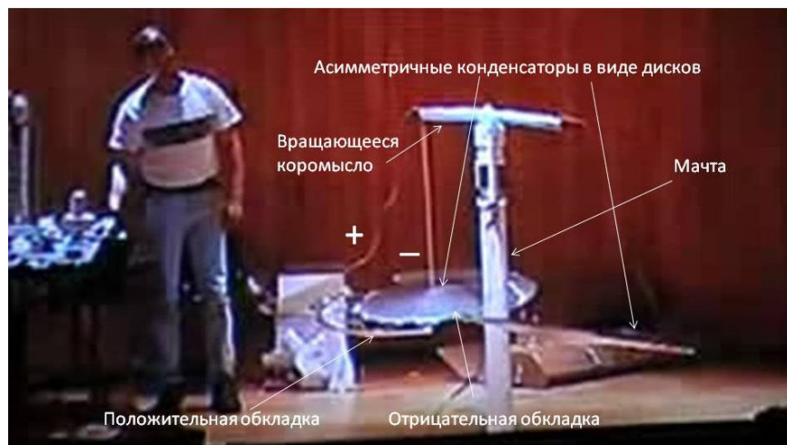
Рис.3. Два двигателя Брауна в виде асимметричных конденсаторов подвешены на вращающемся коромысле
