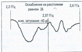
Рисунок 8. График затухания сигнала на расстоянии антенн, равном длине волны 2\lambda , прибор P2-78.
