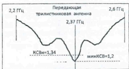
Рисунок 5. График КСВн передающей трилистниковой антенны, прибор P2-78.
