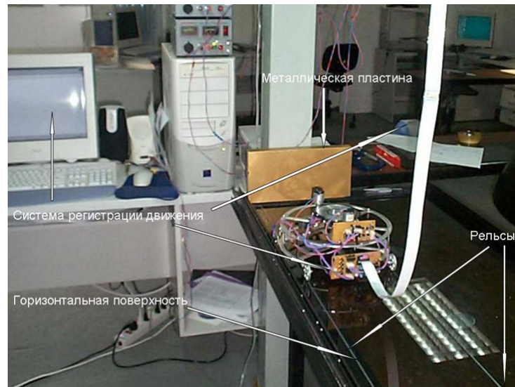
Рис.4. Экспериментальная установка для проверки связи между скоростью центра масс и угловой скоростью вращения грузов
