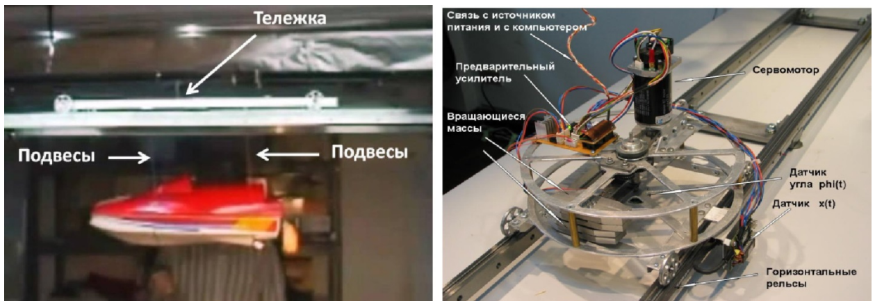
Рис.9. Слева подвешенная к тележке на нитях лодка, справа 4D гироскоп, управляемый через компьютер
