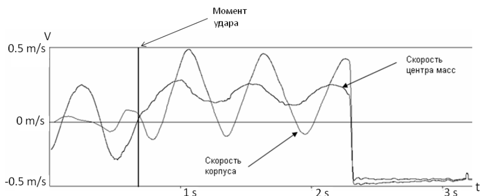
Рис.6 Экспериментальный график пространственно-временной прецессии
