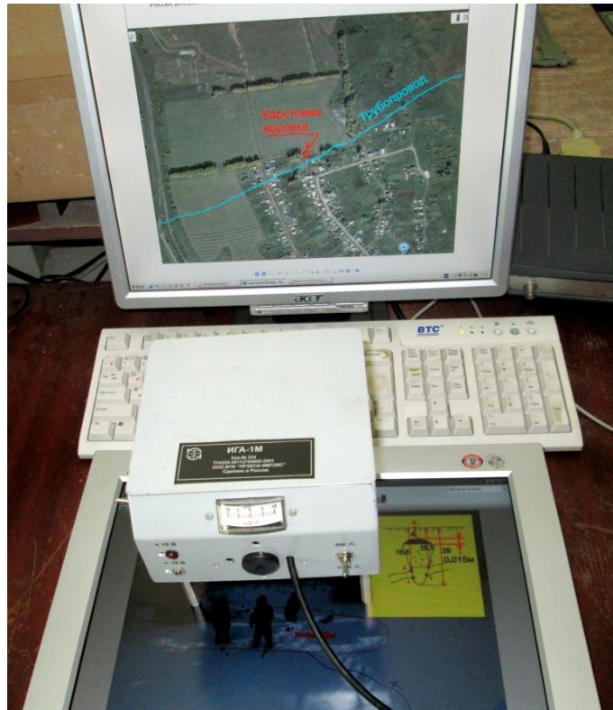
Рис. 6. Стационарный вариант прибора ИГА-1 для дистанционного поиска по картам и космоснимкам
